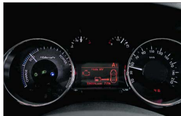
Kuljettaja saa jatkuvasti tietoa niin akkujen tilasta, moottoreiden toiminnasta kuin virran kulustakin. Informaatio juoksee sekä mittaristossa, että kojelaudan päällä olevassa näyttörudussa. Nollapäästökin ovat hetkittäin mahdollisia.
