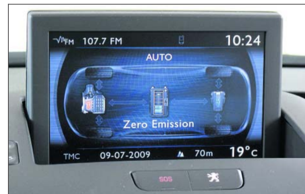
Kuljettaja saa jatkuvasti tietoa niin akkujen tilasta, moottoreiden toiminnasta kuin virran kulustakin. Informaatio juoksee sekä mittaristossa, että kojelaudan päällä olevassa näyttörudussa. Nollapäästökin ovat hetkittäin mahdollisia.
